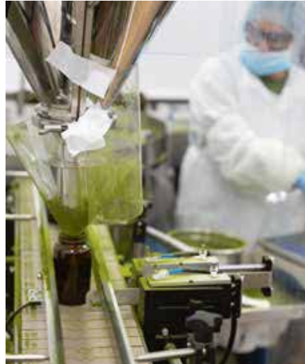
La ligne la plus rapide d'EW Packaging remplit jusqu'à 50 000 bouteilles par jour.
