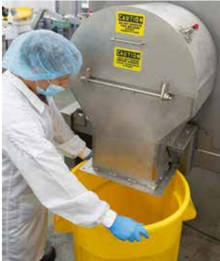
Le mélangeur rotatif par lots charge, mélange et décharge depuis une sortie fixe en environ 15 min.
